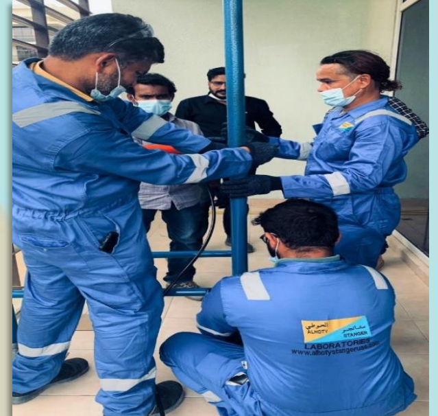
اختبار خاص لحمل الدرايزين من قبل فريق مختبر الحوطي ستانجر- أبو ظبي في مجمع سكني فاخر في أبو ظبي.
